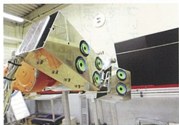
段ボール箱の製函・封函ロボット(上写真)。中央の6軸ロボットが写真奥に見える専用器具に段ボールを通して製函・封函を行う。下の写真は段ボールをつかむハンド
