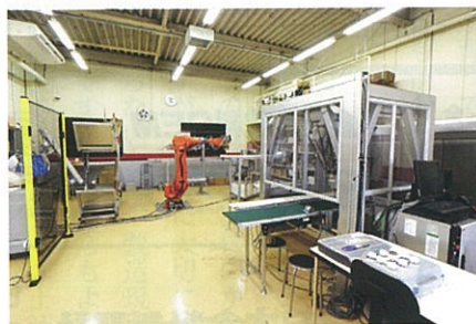
ロボット研究開発所の内部。奥に6軸ロボット、右側にパラレルリンクロボットの仮設ラインが見える
