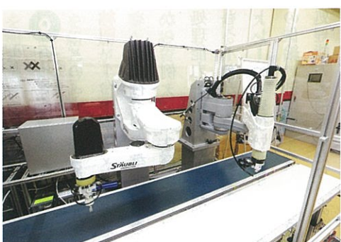
スカラロボットは高速搬送用(最大200サイクル/分)と中速搬送用(最大40サイクル/分)を用意。処理スピードの比較や2種類を組み合わせたの検討なども行える
